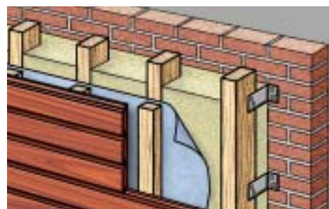
Opbouw gevelbekledingsconstructie bij een steenachtig binnenspouwblad.
